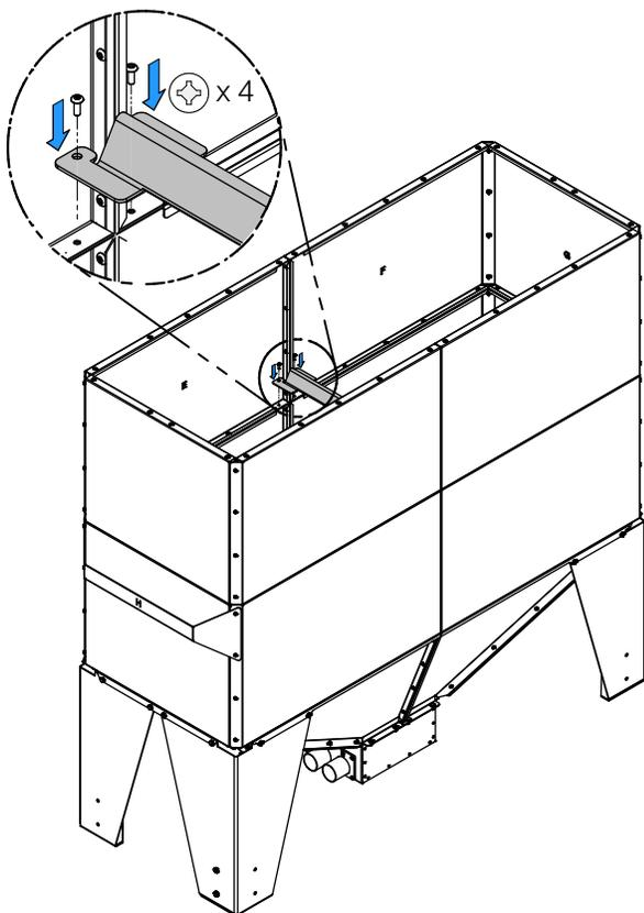
8. Réinstaller l'étage, le renfort avec les vis.
