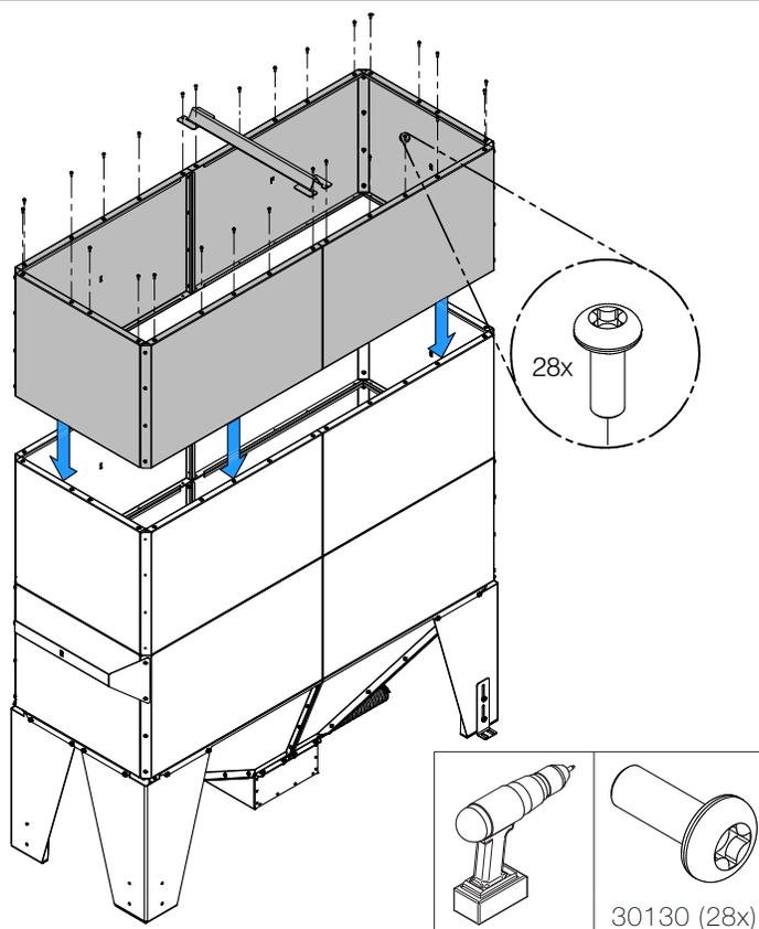
9. Réinstaller le dessus du réservoir, les panneaux et les pentures.
