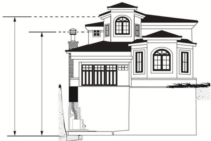
Figure 9 : Emplacement de la cheminée
