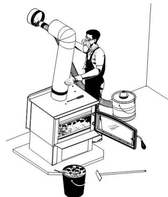
1. Fermer la porte et le contrôle d'admission d'air du poêle;
