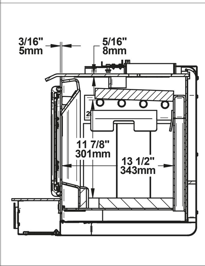
Figure 7: Vue de côté - Chambre à combustion
