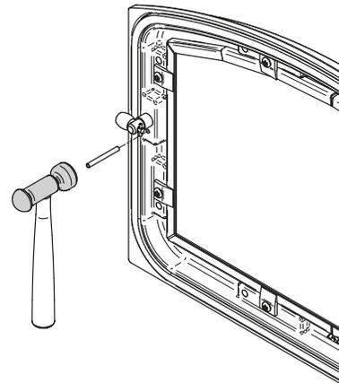
Figure 18: Installation de la goupille de retenue
