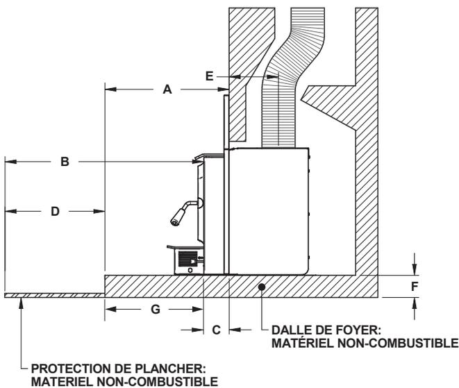
Figure 21: Protection de plancher aditionnelle - Installation surélevée
