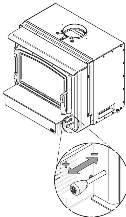
Figure 14: Contrôle de l'admission d'air
