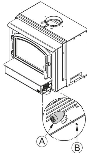
Figure 9: Installer la poignée du contrôle d'air
