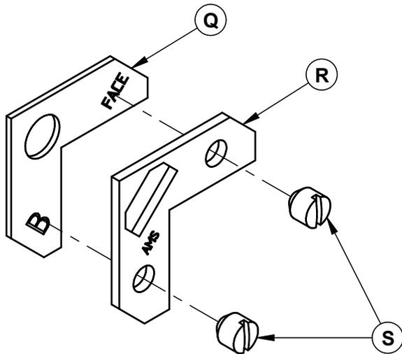
4. Insérer les équerres **(Q)** et **(R)** superposé avec les vis **(S)** dans les rainures de chaque moulure décorative **(T)**, **(U)** et **(V)**. Aligner les coins du côté à angle de chaque moulure, puis serrer les vis **(S)** pour sécuriser l'ensemble de moulures.
