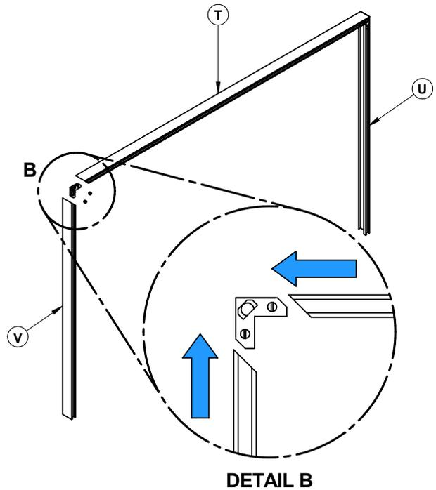
5. Aligner l'ensemble de moulures assemblées sur le bord gauche et droit de la façade et faites-le glisser lentement vers le bas le long de la façade.
