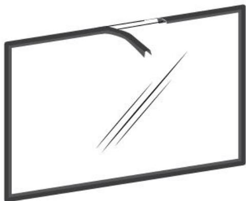
Figure 16: Joint d'étanchéité de la vitre
