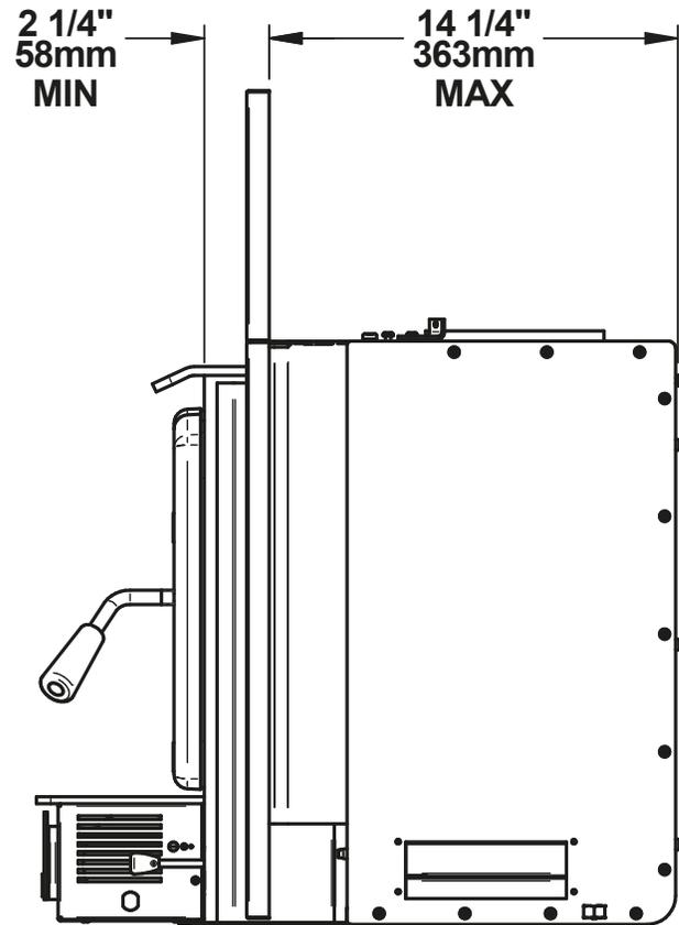
Figure 2: Vue de côté - Projection minimum
