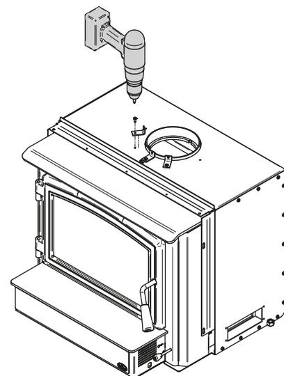
Figure 27: Installation des équerres
