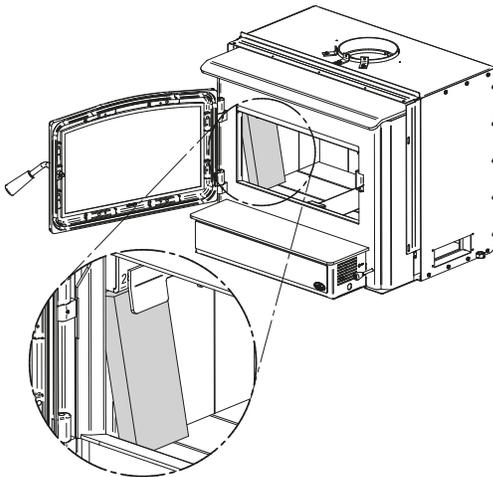
Figure 10: Installer les briques de côté
