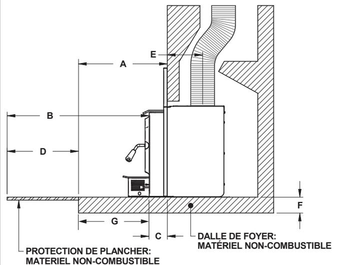
Figure 22: Protection de plancher aditionnelle - Installation non surélevée
