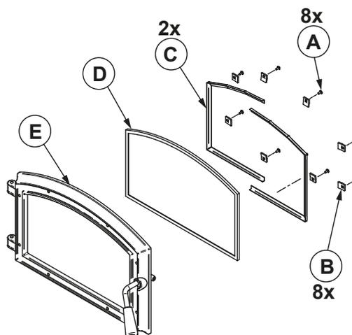
Figure 15: Remplacement la vitre
