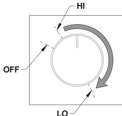
Figure 13: Rhéostat du ventilateur
