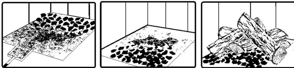
Le déplacement des braises est utile pour deux raisons. Tout d'abord, cela les rassemble près de l'endroit où la plus grande partie de l'air entre dans la chambre à combustion. Elles peuvent enflammer la nouvelle charge rapidement. Deuxièmement, les braises ne seront pas étouffées par la nouvelle charge de bois. Lorsque les braises sont simplement étalées, la nouvelle charge brûle en amortissant longtemps avant de s'enflammer.
