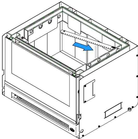
1. En commençant vers l'arrière, incliner et insérer le tube d'air secondaire arrière dans le trou du fond de la canalisation droite. Ensuite, lever et pousser le tube vers la gauche dans le trou correspondant de la canalisation de gauche.
