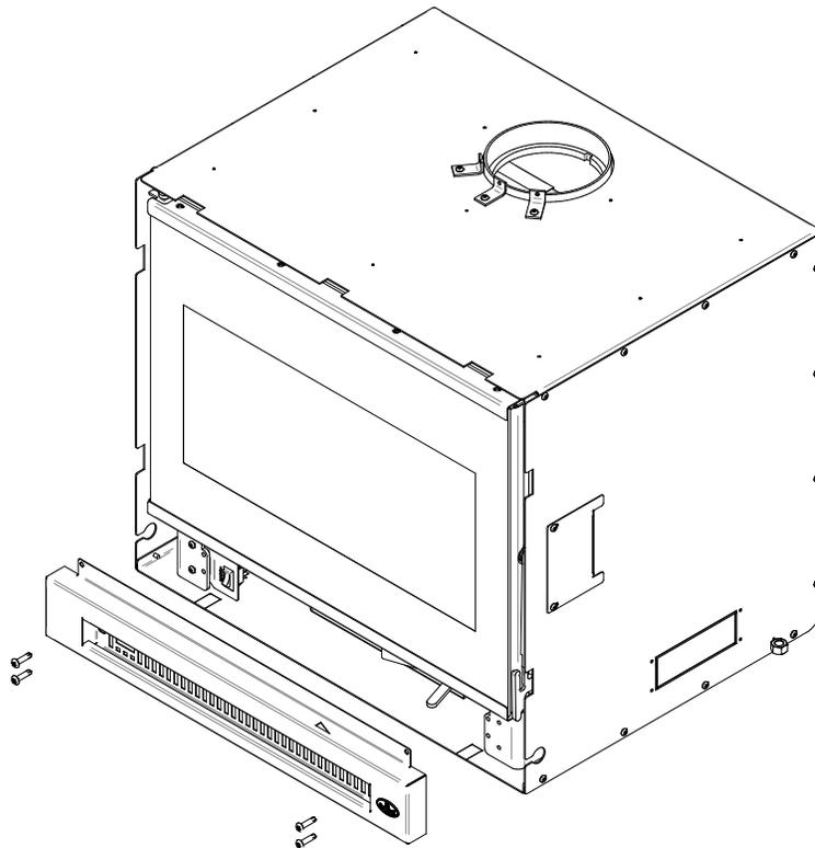
3. Localiser le couvercle du contrôle d'air, sous l'encastable.
