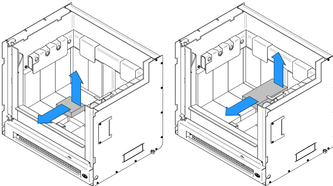
2. Retirer les autres briques de plancher (6). Ensuite, retirer les deux pierres du bas, dans le dos (2).
