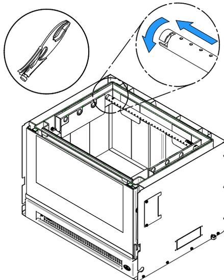
2. Aligner le chemin du tube et la dent dans le trou de la canalisation. Tenir le tube à l'aide d'une pince de serrage et suivre le mouvement décrit dans la figure ci-contre pour le sécuriser en place. S'assurer que la dent touche le fond du chemin du tube.
