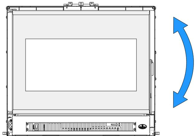
Figure 32: Ajustement haut-bas de la porte
