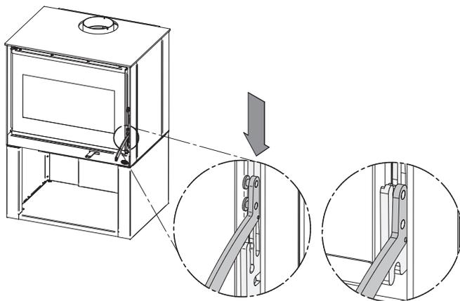
Figure 20: Ouverture à droite de l'encastrable
