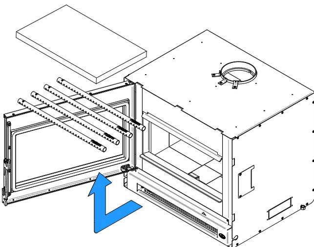
3. Répéter les étapes 1 et 2 pour le deuxième tube d'air secondaire arrière. *Installer le coupe-feu avant d'installer les deux tubes avant.*
