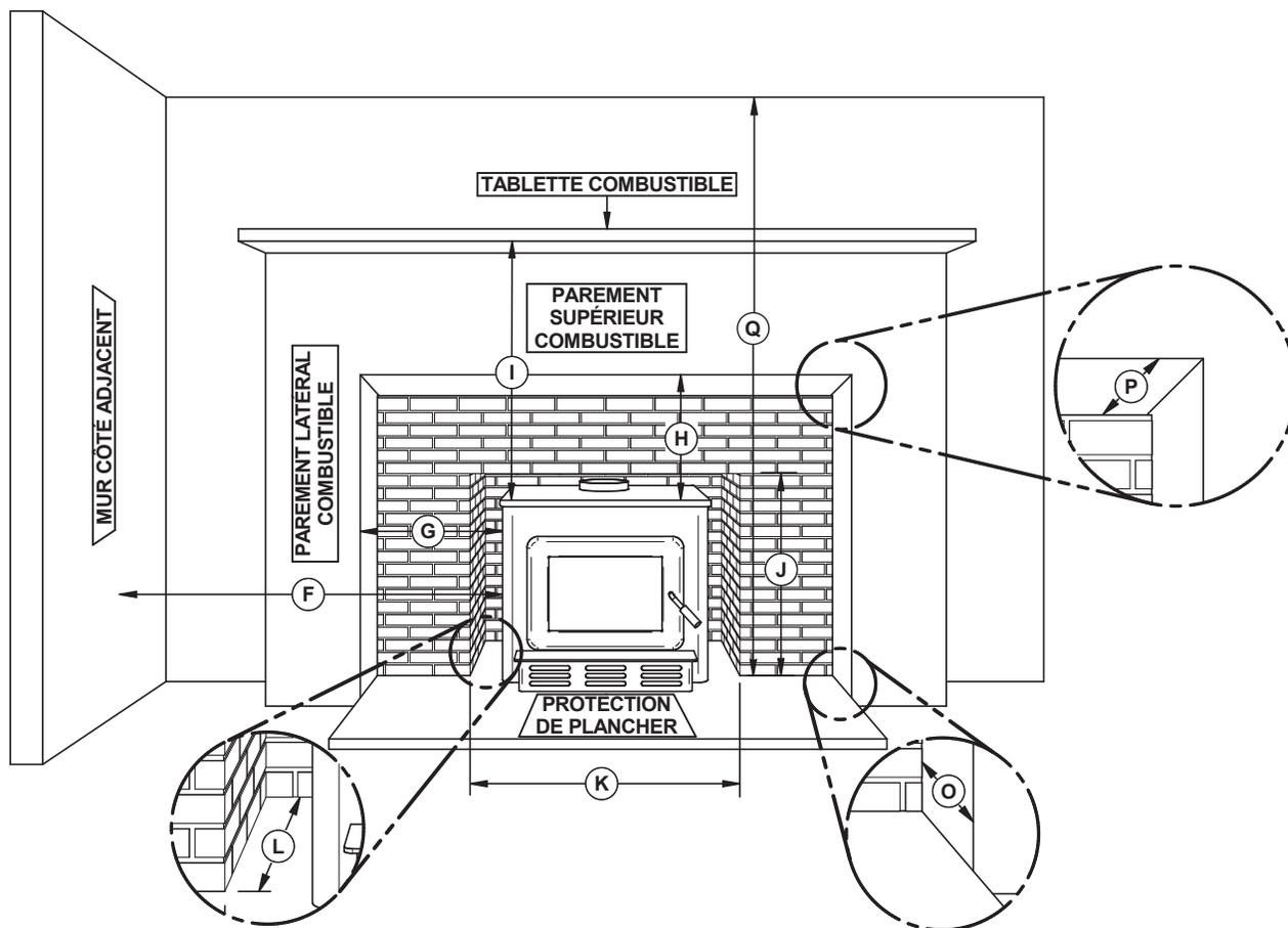
Figure 39: Ouverture de l'âtre et dégagements aux combustibles
