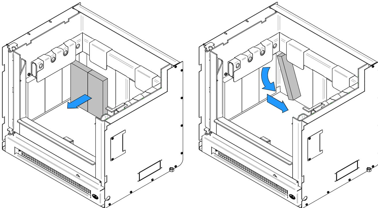
4. Retirer le reteneur de briques (1) ainsi que les briques du côté gauche (3). Répéter pour le côté droit.
