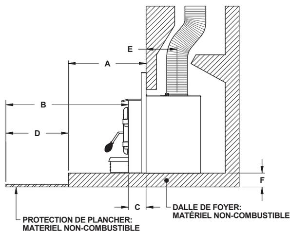
Figure 38: Installation surélevée de plus de 5"
