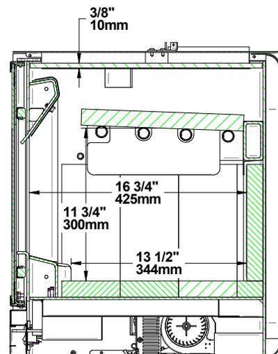
Figure 6: Vue de côté - Chambre à combustion
