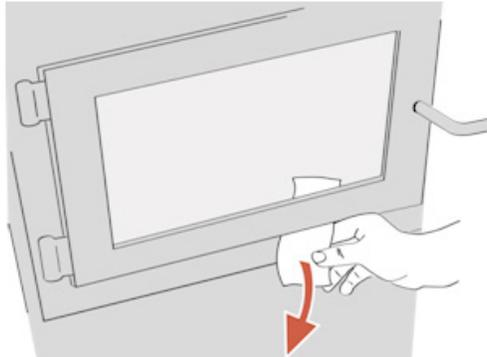
Figure 28: Vérification du joint de la porte
