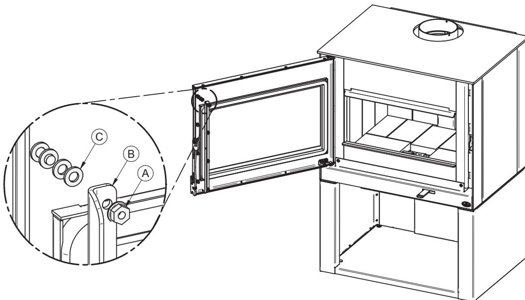
Figure 29: Ajustement de la porte avec l'équerre
