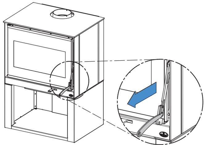
Figure 21: Tirer sur la main froide pour ouvrir la porte
