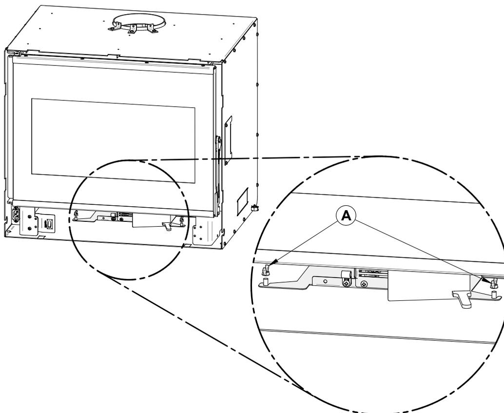
6. Tourner le ventilateur dans le sens contraire des aiguilles d'une montre et tirer doucement sur le ventilateur.
