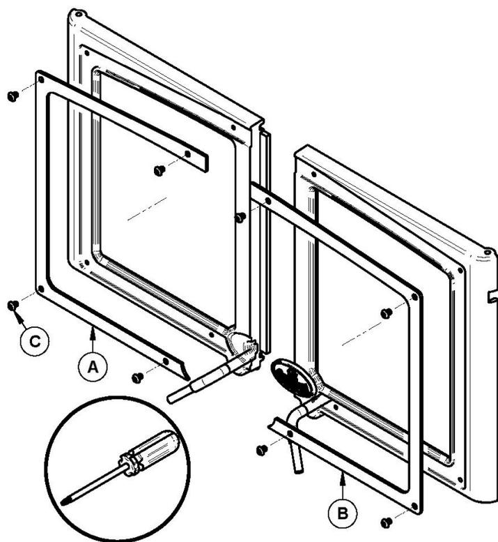
Positionnez les revêtements (A) et (B) sur les portes et fixez-les en place par l'intérieur de la porte en utilisant les 8 vis (C) fournies.
