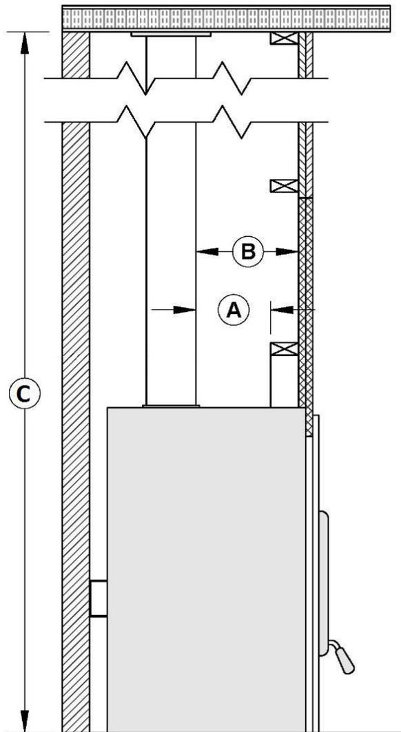
Installation avec une finition derrière la façade du foyer.
