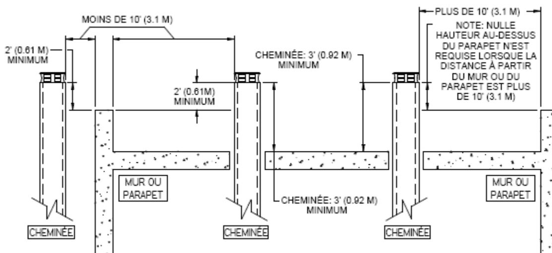
12. Dans le cas des installations où plus d'une cheminée est sur le même tablier non-combustible ou dans le même secteur, nous vous suggérons d'en éloigner les extrémités d'au moins 16" (410 mm) horizontalement et 18" (460 mm) verticalement. Ceci à pour but d'éviter que la fumée ne passe d'une cheminée à l'autre.
