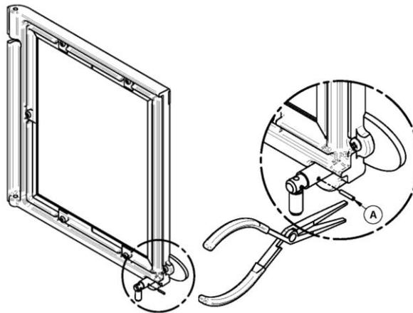
2. Tournez la poignée un tour dans le sens contraire des aiguilles d'une montre afin d'augmenter la pression entre le cadrage de la porte et la structure du foyer. Pour réduire la pression, dans le cas d'un joint neuf par exemple, tournez dans le sens des aiguilles d'une montre.
