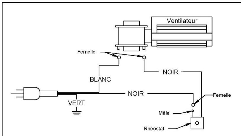
**AVERTISSEMENT : ASSUREZ-VOUS QUE LE CORDON ÉLECTRIQUE DU VENTILATEUR ET/OU DU THERMODISQUE NE TOUCHE À AUCUNE SURFACE DU POÊLE DE FAÇON À ÉVITER LES DÉCHARGES ÉLECTRIQUES OU LES INCENDIES. NE FAITES PAS PASSER LE CORDON ÉLECTRIQUE SOUS LE POÊLE.**
