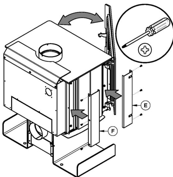
8. Remettez en place les panneaux latéraux (E) et la vis (F).
