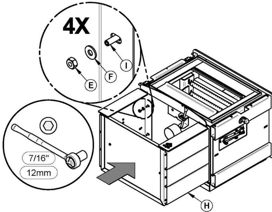
9- Assemblez le piédestal (H) sur des boulons (I), à l'aide des écrous (E) et rondelles (F) conservées à l'étape 6.
