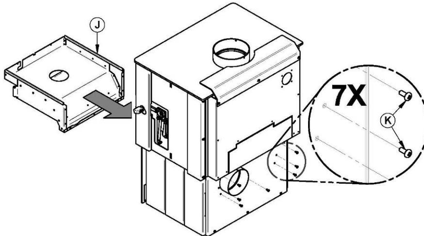
10- Insérez le boîtier d'entrée d'air frais (J) et sécurisez par l'arrière avec 7 vis (K).
