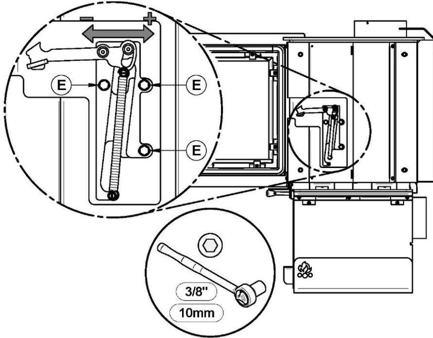
5. Ajustez le serrage de la porte en dévissant légèrement les boulons (E). Plus le mécanisme est éloigné de la porte, plus le serrage est fort.
