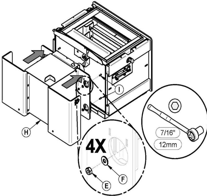
7- Assemblez la base (H) sous l'appareil à l'aide des écrous (E) et rondelles (F) conservées à l'étape 6. Assemblez sur les boulons (I).
