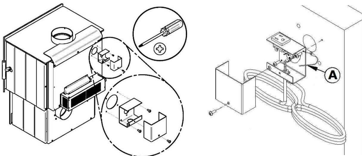
Lorsque le ventilateur est utilisé sans le raccordement au thermodisque, il faut laisser le poêle atteindre sa température de marche (environ une heure) avant d'actionner le ventilateur. L'augmentation du courant d'air produit par le ventilateur refroidit la chambre à combustion et peut nuire au rendement d'un début de combustion si le ventilateur démarre trop tôt.
