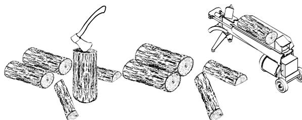
Le bois devrait être fendu de différentes grosseurs, allant de 3 po. à 6 po. (75 mm à 150 mm) d'épaisseur. Il est beaucoup plus facile d'allumer et de raviver un feu avec des bûches de différentes grosseurs. Souvent, le bois de chauffage acheté d'un fournisseur commercial n'est pas fendu assez petit pour alimenter un feu. Il est parfois préférable de refendre le bois avant de le corder pour qu'il sèche.
