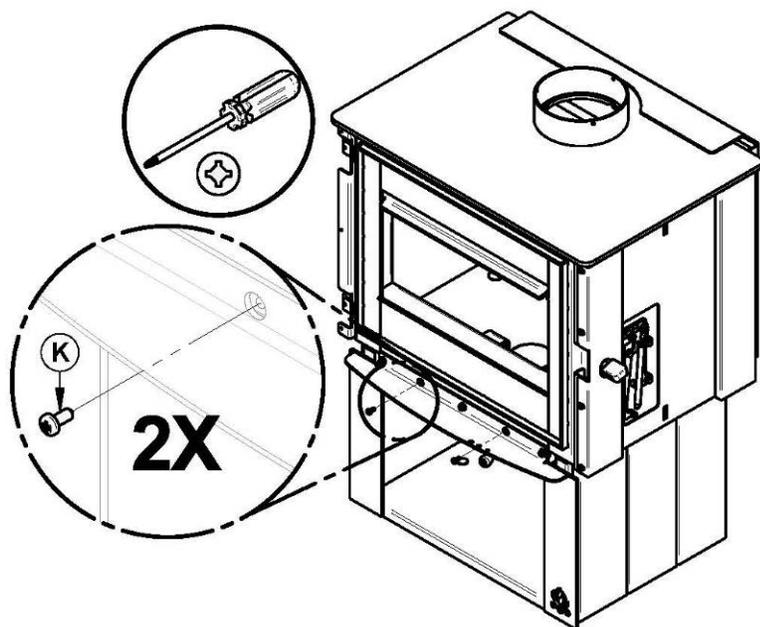
11- Installez le boîtier d'entrée d'air frais derrière la tablette à cendre et fixez à l'aide de 2 vis (K).
