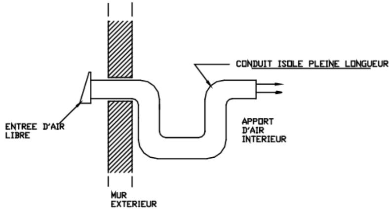
Un tuyau métallique isolé de 3" de diamètre intérieur, souple ou rigide, doit être relié à l'adaptateur d'air frais (D).
