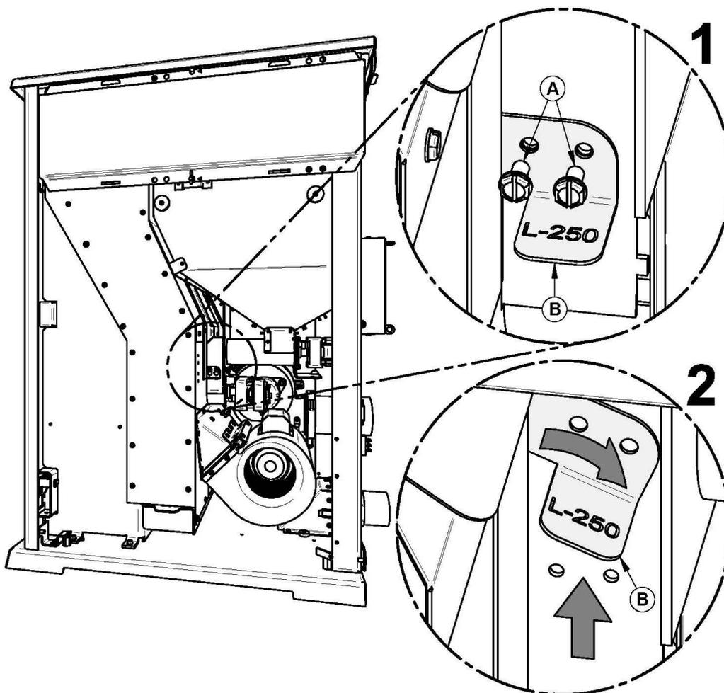
Retirez l'interrupteur thermique défectueux. Installez le nouveau (D) par le dessous de l'équerre de support (B) à l'aide des deux vis (C).
