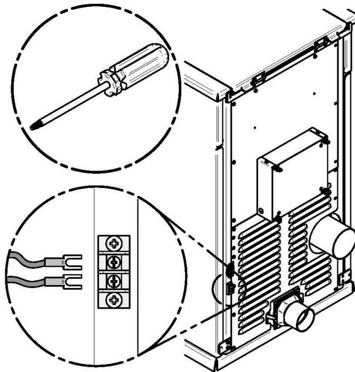
Voici un exemple de connexion au thermostat:
