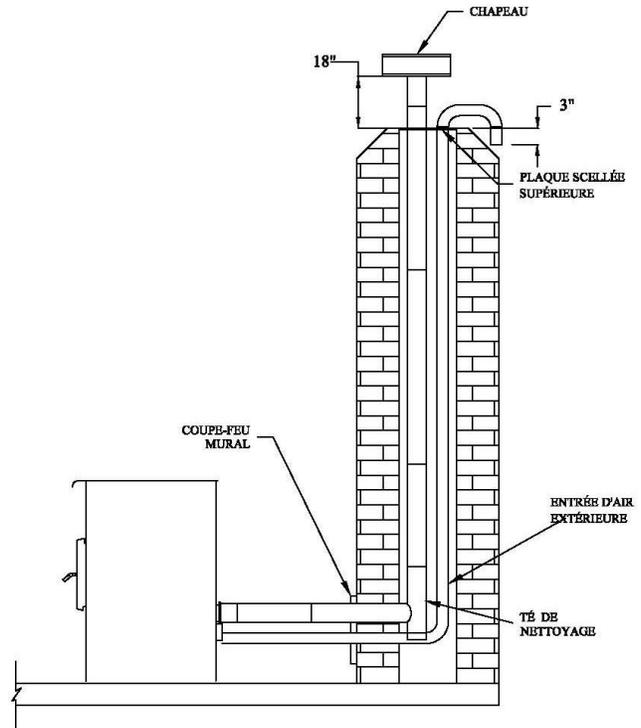
5. Installez un "té" de nettoyage dans la partie inférieure du tuyau d'évacuation jusqu'à ce que le centre de la buse de raccordement du "té" soit aligné avec le centre du trou dans la maçonnerie.
