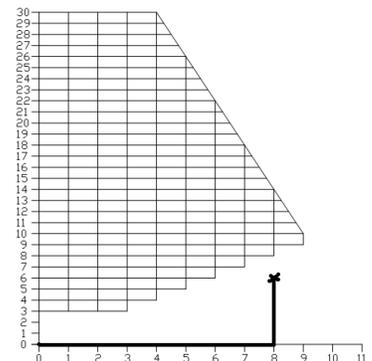
Par contre, si l'installation consiste en un parcours horizontal de 4 pieds, suivi d'un raccord en « T » et d'un parcours vertical de 6 pieds, elle est adéquate. L'installation se termine clairement à l'intérieur de la zone recommandée sur le graphique puisqu'elle comporte au moins un pied de longueur verticale pour chaque pied de longueur horizontale. De plus, la totalité du parcours vertical n'est pas inférieure à 3 pieds.
