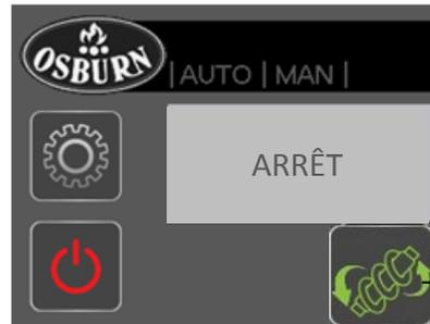
Commande d'arrêt de la vis d'alimentation
