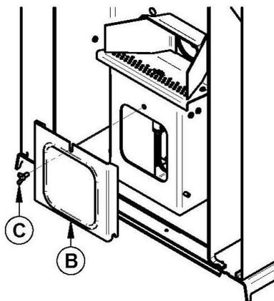
5. Vérifiez que le joint d'étanchéité de la trappe d'accès est en bonne condition, sinon remplacez-le (cordon rond 3/16" noir (AC06815)).
