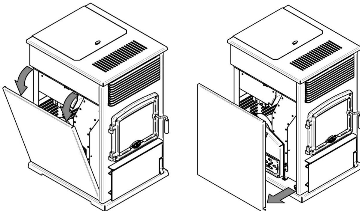
Pour retirer les deux panneaux d'accès, il faut pousser et tourner dans le sens antihoraire sur la vis centrale avec un tournevis carré ou cruciforme.
