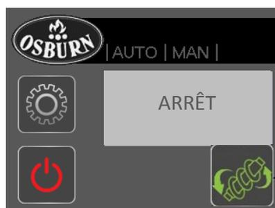
Commande d'arrêt de la vis d'alimentation
