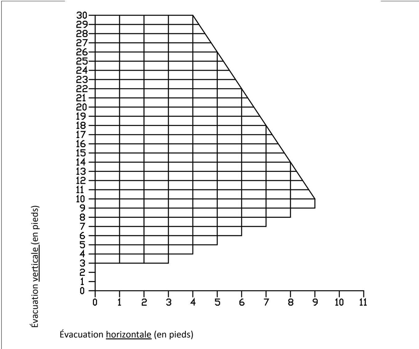
Imaginons une installation dont la sortie arrière consiste en un parcours horizontal de 8 pieds, suivie d'un raccord en « T » et d'un parcours vertical de 6 pieds. Ce type d'installation ne serait pas conforme. En effet, la terminaison murale se situe clairement à l'extérieur de la zone recommandée sur la charte puisqu'elle **ne comporte pas au moins un pied de longueur verticale pour chaque pied de longueur horizontale**.
