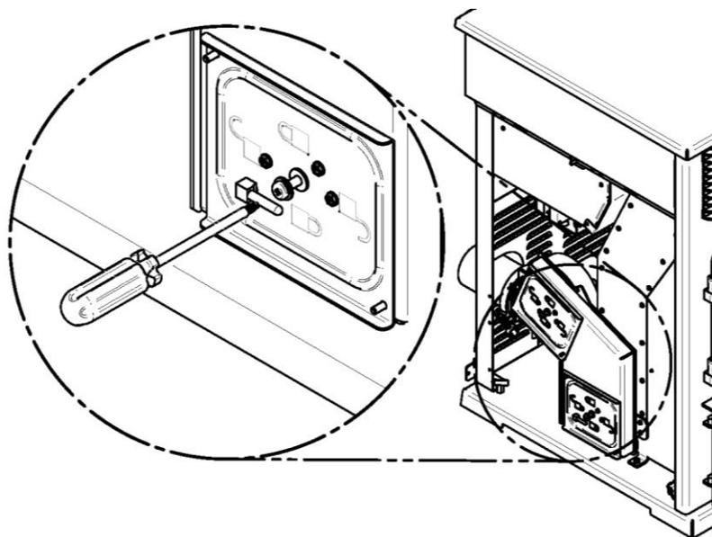
Repérez les deux ouvertures. Nettoyez toute saleté ou accumulation de cendres dans les deux canalisations d'évacuation en utilisant le grattoir fourni avec le poêle. Utilisez un aspirateur à cendres pour compléter le nettoyage.
