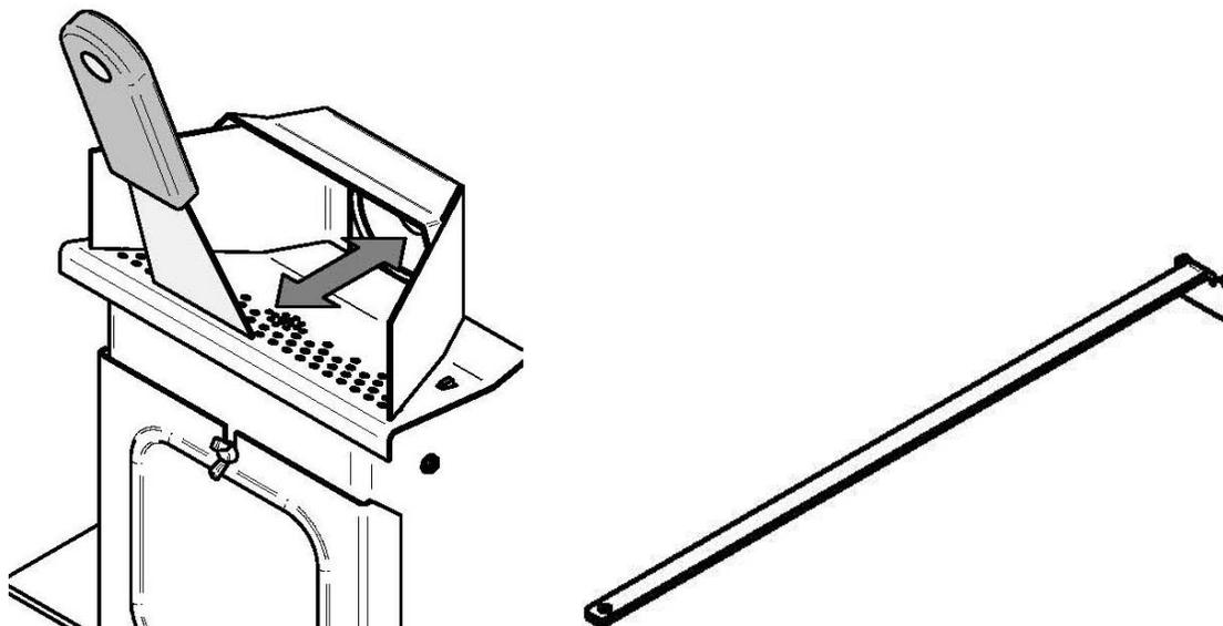
2. Le pot de combustion est simplement déposé sur la canalisation d'entrée d'air, vous devez donc le soulever pour le retirer du poêle. Deux petits tenons guident le pot en place, assurez-vous qu'il est bien appuyé avant de mettre en marche le poêle.
