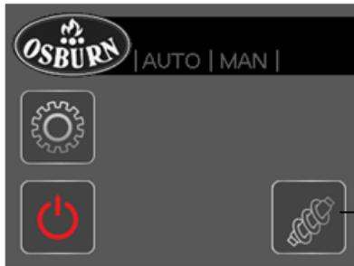
Appuyer sur la commande d'alimentation de vis à granule
