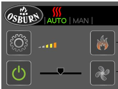
Commande d'ajustement du taux de combustion
