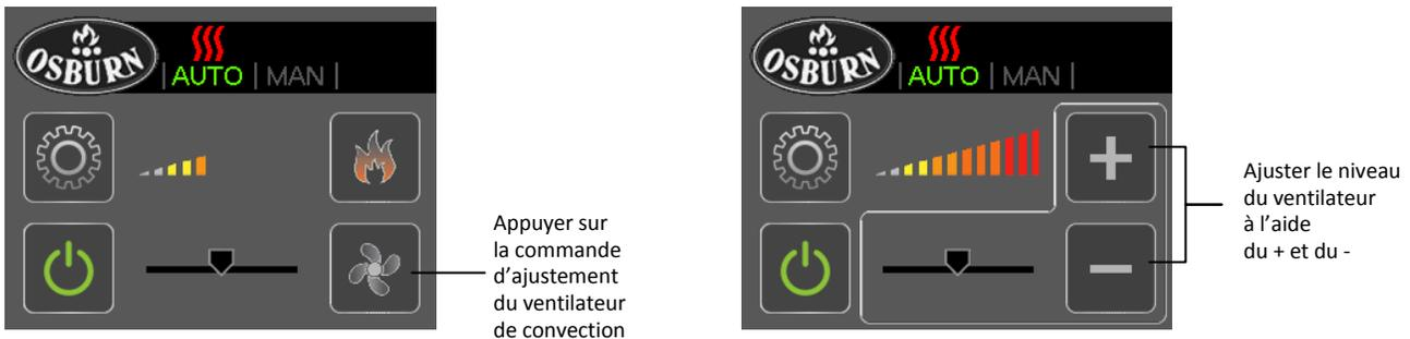
En cas de surchauffe, la vitesse du ventilateur de convection sera automatiquement mise au maximum et une icône d'enveloppe affichera sur la page d'accueil principale. Appuyez sur l'icône de l'enveloppe pour voir le message d'avertissement. Pendant ce temps, le ventilateur de convection se mettra à son réglage le plus élevé jusqu'à ce que le poêle ait atteint une température sécuritaire. Lorsque le poêle aura atteint cette température, il retournera à la vitesse précédemment sélectionnée.
