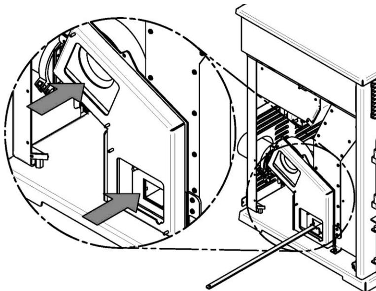
Vérifiez que les joints d'étanchéité des panneaux soient encore en bon état, les remplacer au besoin.
