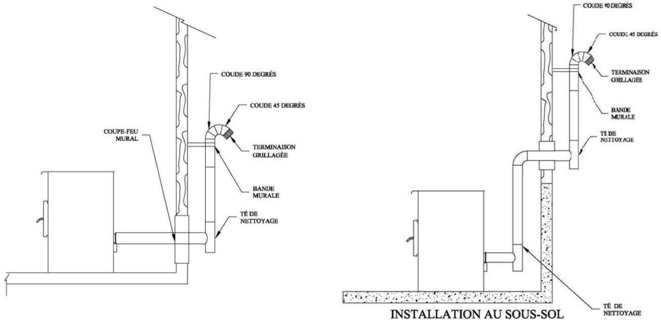
1. Positionnez le poêle en respectant les dégagements mentionnés à la **Section 3, Dégagements aux matériaux combustibles** ainsi que ceux fournis par le fabricant du système d'événement. Marquez la position de la buse de raccordement au mur derrière.
