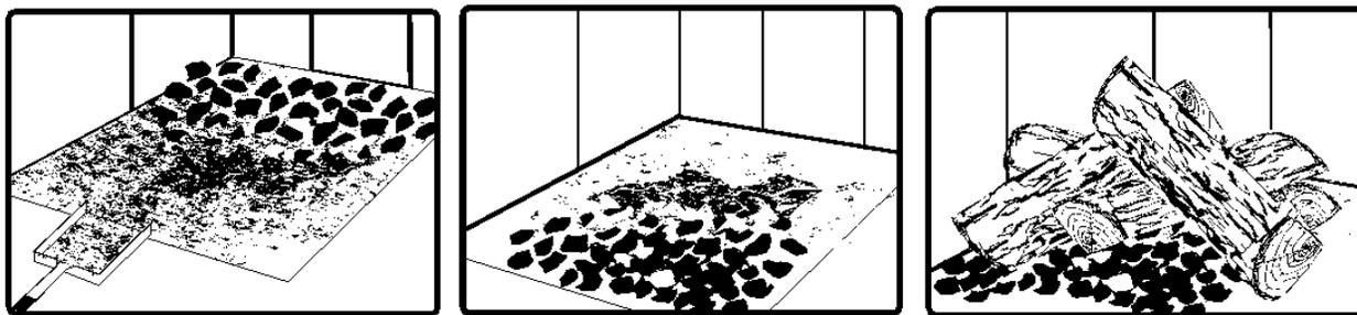
*Enlever les cendres, puis déplacez les braises vers l'avant de la chambre à combustion avant de remettre du bois pour qu'elles enflamment la nouvelle charge.*
