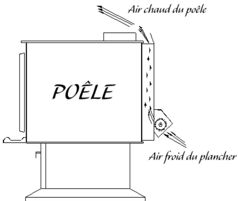
**AVERTISSEMENT : ASSUREZ-VOUS QUE LE CORDON ÉLECTRIQUE DU VENTILATEUR NE TOUCHE À AUCUNE SURFACE DU POÊLE DE FAÇON À ÉVITER LES DÉCHARGES ÉLECTRIQUES OU LES INCENDIES. NE FAITES PAS PASSER LE CORDON ÉLECTRIQUE SOUS LE POÊLE.**
