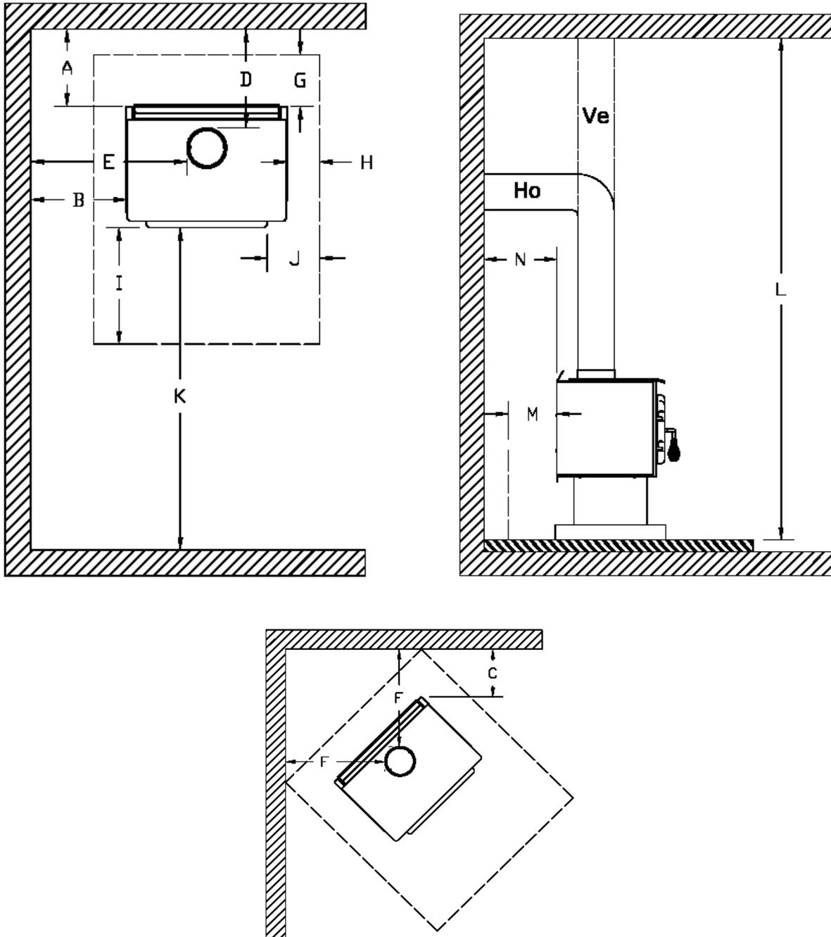
**Dégagements aux matériaux combustibles et protection du plancher**
